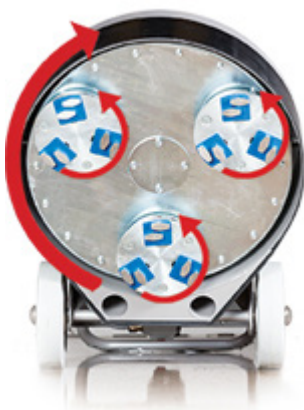
Figur 41 Illustrerar hur slipskivorna rör sig i förhållande till sliphuvudet.
